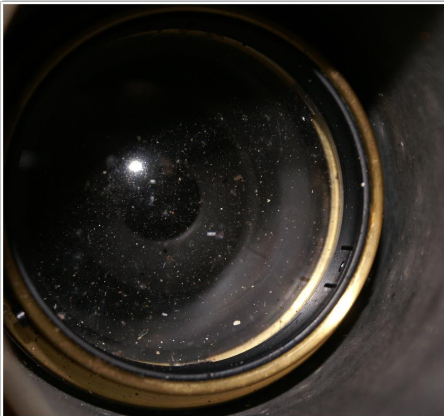
Zeiss Asegur vermutlich AS 63/840 mm , 1 Tubusblende sichtbar. 10/2014
