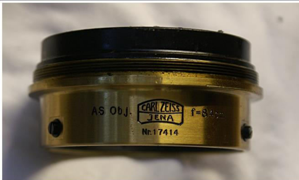
AS Objektiv mit 60 mm freier Öffnung und f=84 cm Seriennummer 17414
