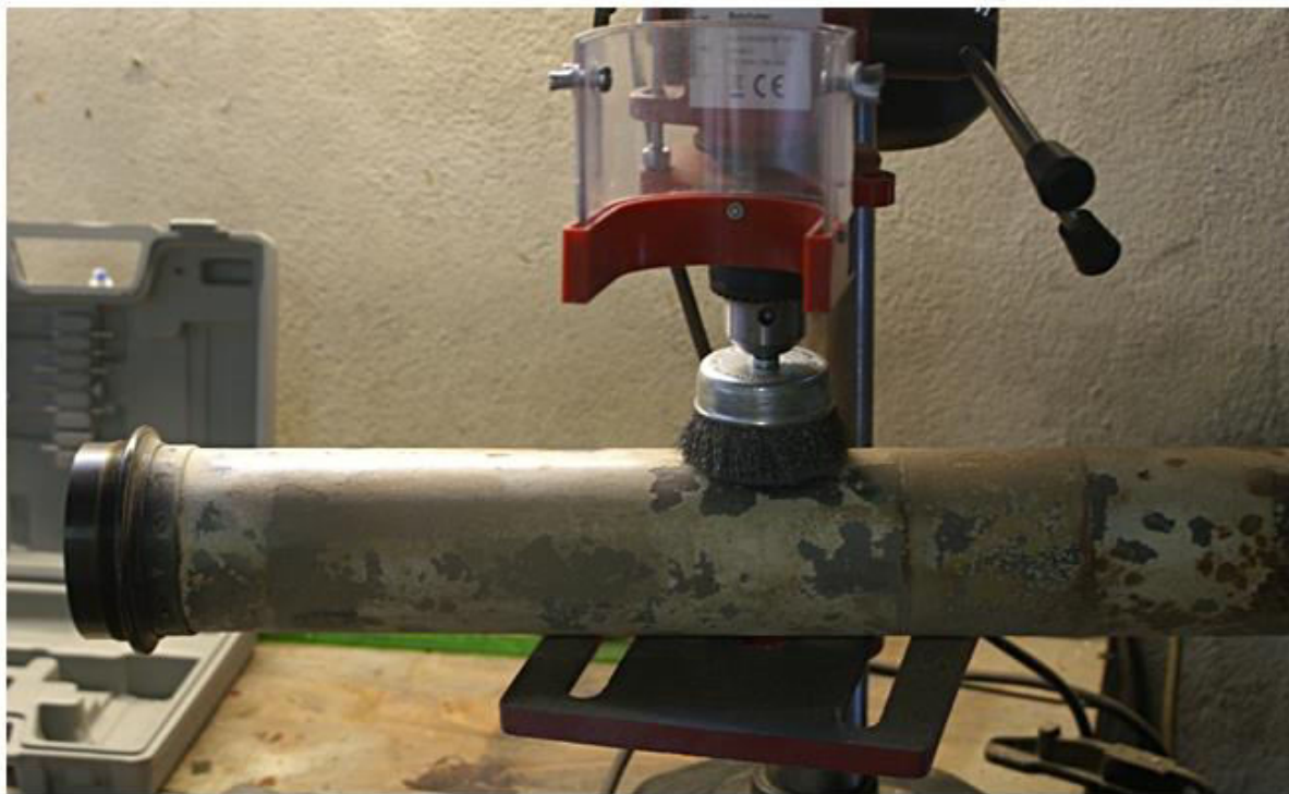
Erstes Abtragen der völlig zerstörten Tubuslackierung und Entrostung am 08.10.2014
