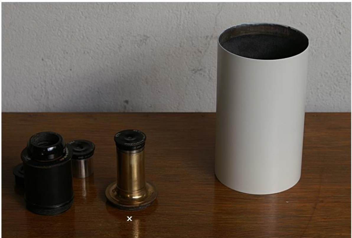
Taukappe mit neuer Lackierung - zu Position "X" : am 20.10.2014 gelang es endlich, die Okularaufnahme vom Auszugsrohr abzuschrauben. Diese saß bis dahin völlig fest. Ebenso konnte endlich das Okular gelöst werden. Auch dieses war festgerostet !
