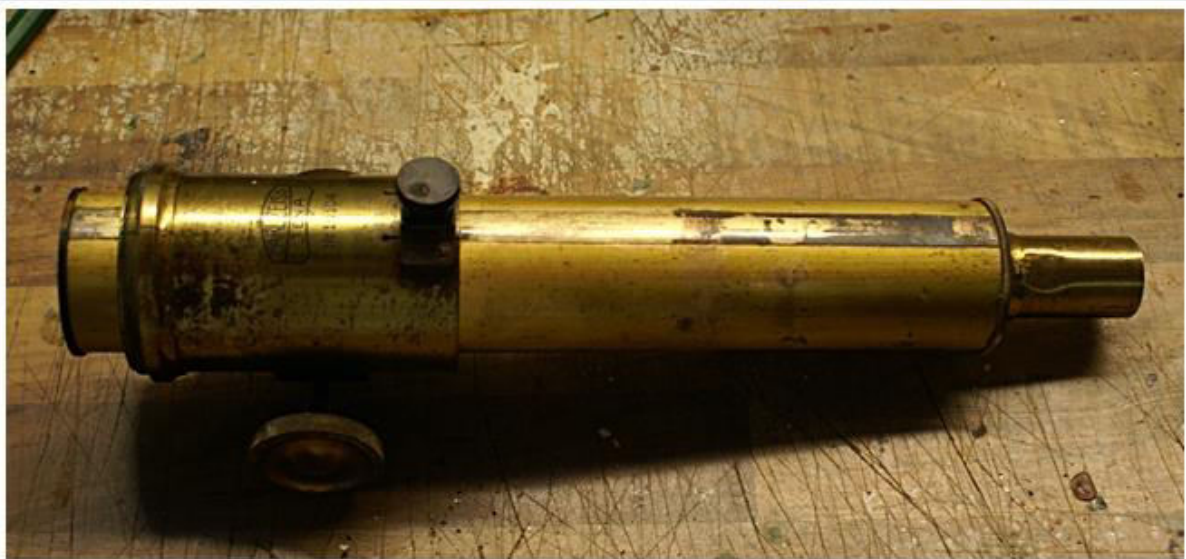
OAZ ausgebaut am 08.10.2014 after 5 days lubricating with WD-40 and use of a hair-dryer !
