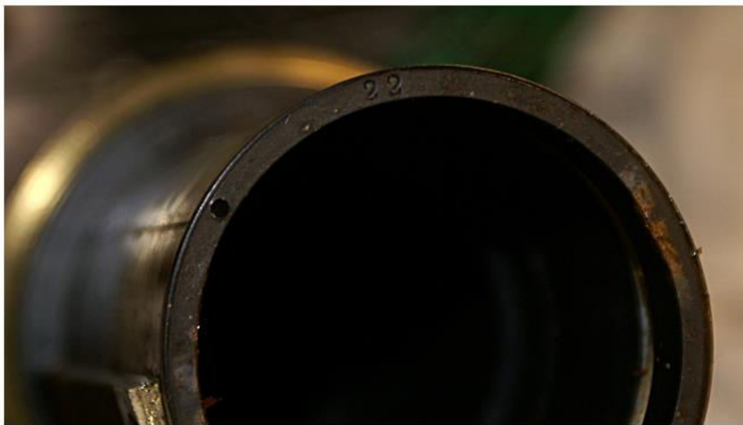
Anschlagring am Auszugsrohr mit Schlagzahl "22" gekennzeichnet
