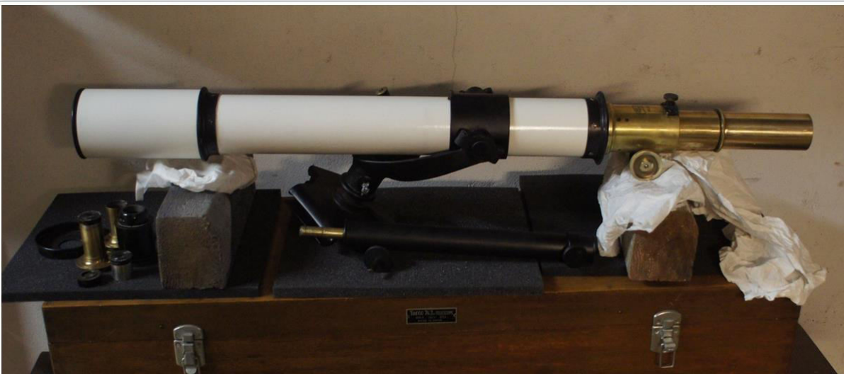
Zeiss Asegur 17.02.2015 : alle Teile wieder beweglich, alles entrostet, neu lackiert. Fast alle Gewinde nachgeschnitten, da völlig verrostete Schrauben ausgebohrt werden mussten. Es sind nur noch letzte Feinarbeiten notwendig, wie z.B. Tubus-Innenschwärzung, Nachbesserung von kleinen Lackschäden und Endpolitur Messingteile ! Objektiv wurde von W. Grzybowski fachmännisch gereinigt, justiert und mit Strehl 0.94 vermessen !
