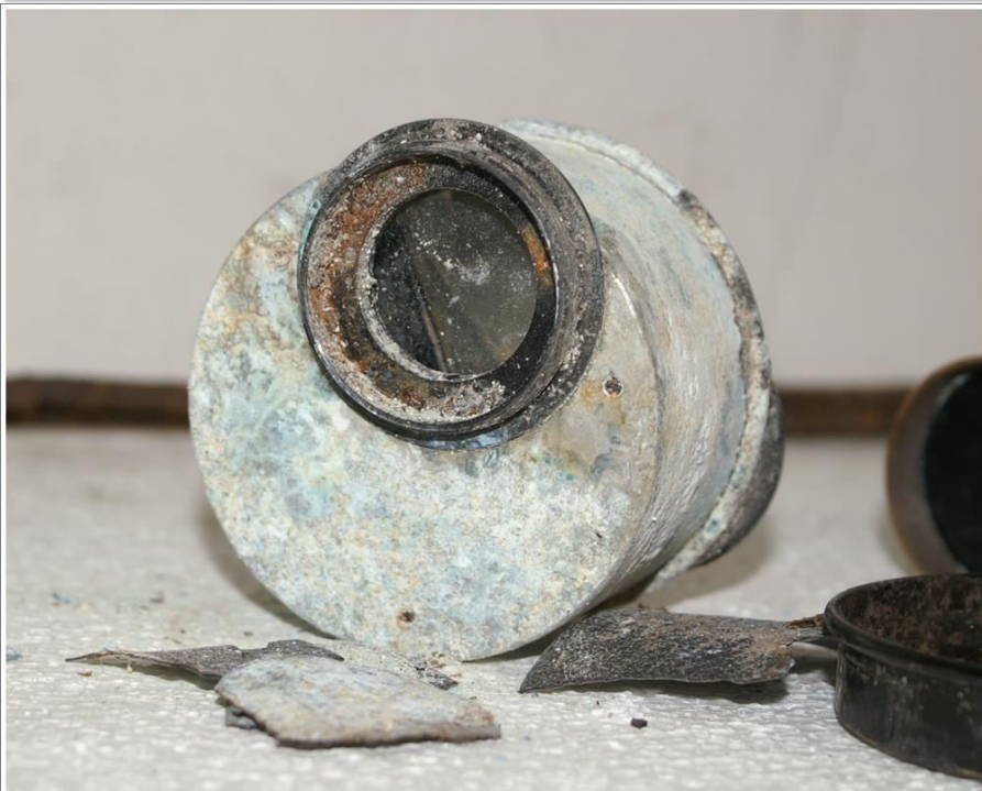
Zeiss Asegur verrottetes Porroprisma 10/2014
