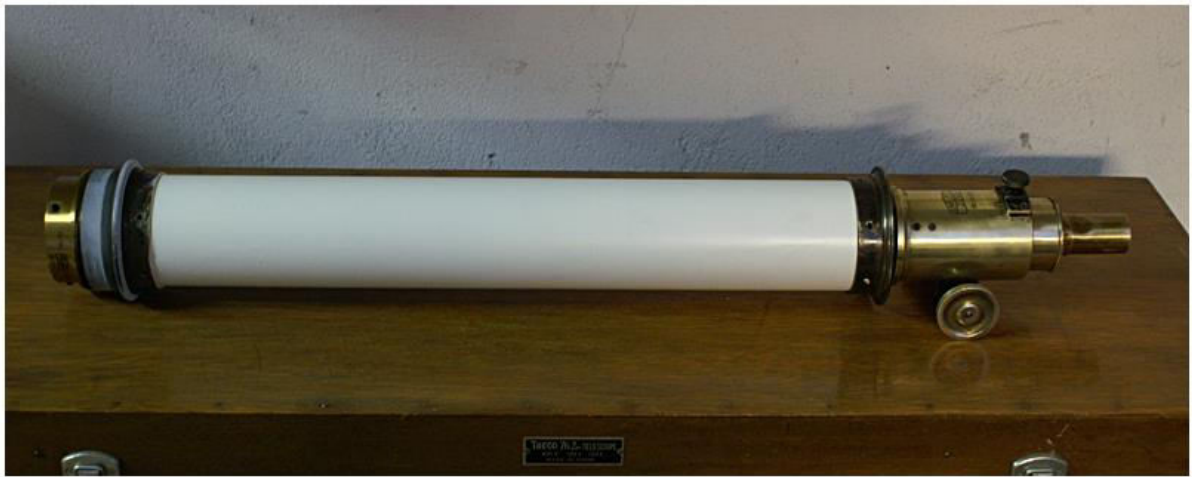
Zeiss Asegur nach Teil-Restaurierung. Erster provisorischer Zusammenbau am 15.10.2014. Es fehlen noch Anbauteile und auch die Tubus-Endringe müssen noch neu lackiert werden und weisen hier z.T. noch die Grundierung auf. Es sieht aber schon wieder ein wenig wie ein Fernrohr aus !
