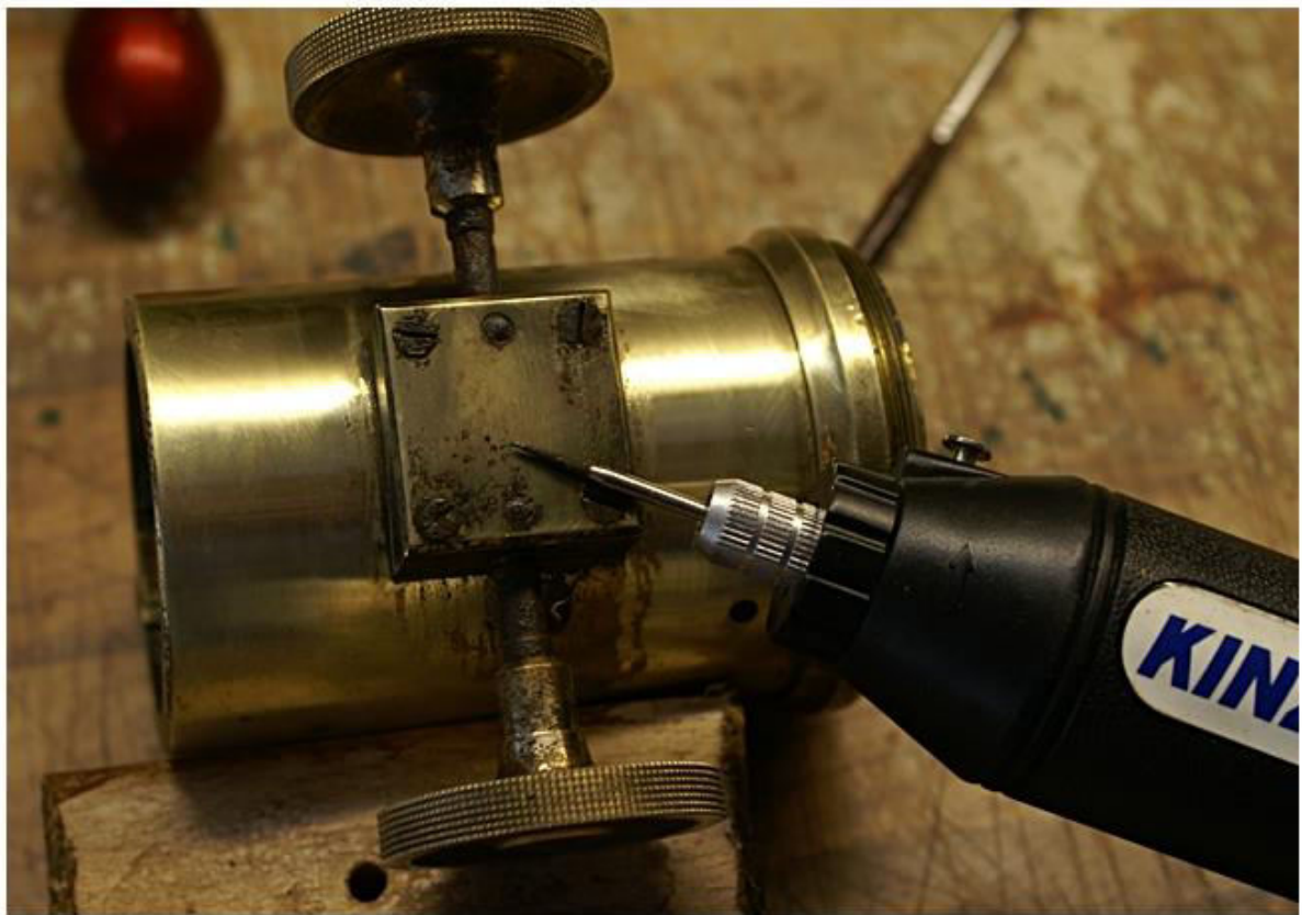
Zeiss Asegur : Reinigen und frei machen der Schlitze in den Schraubköpfen
