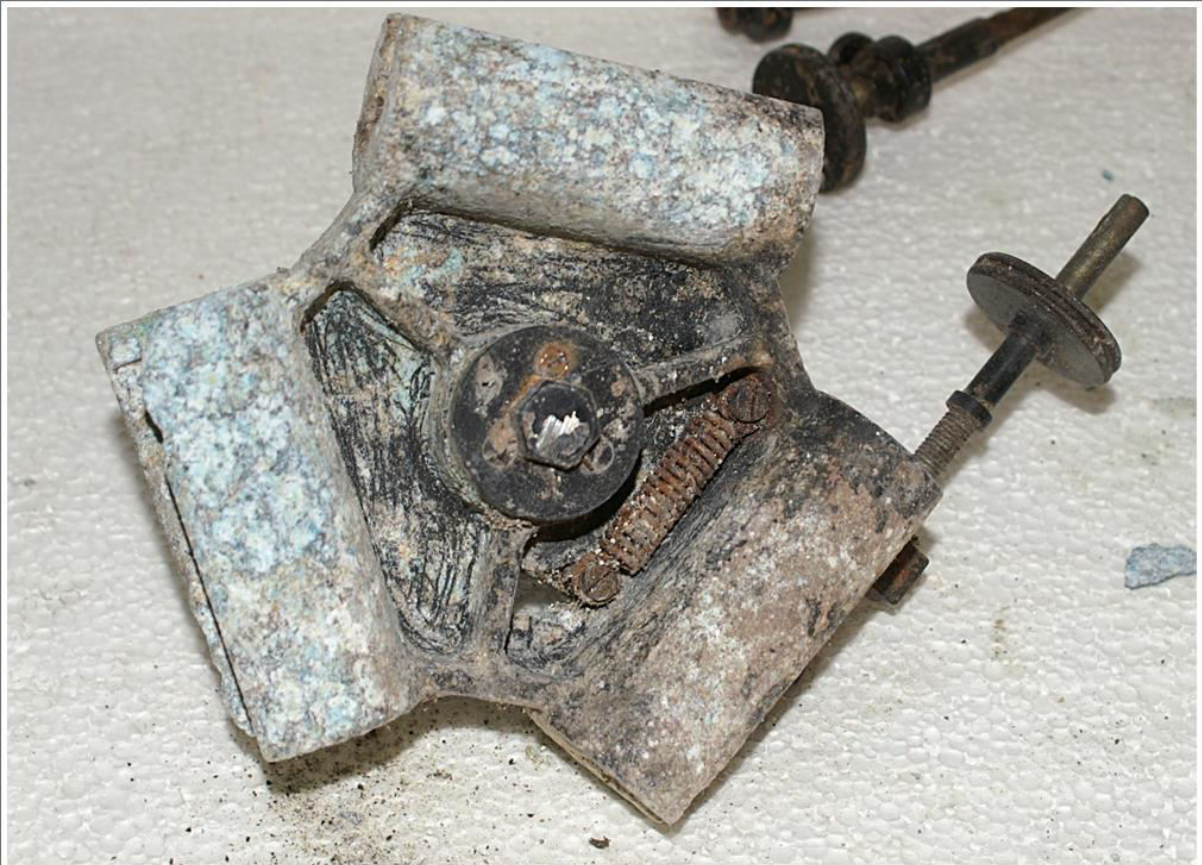
Zeiss Asegur verrottetes Stativplatte 10/2014
