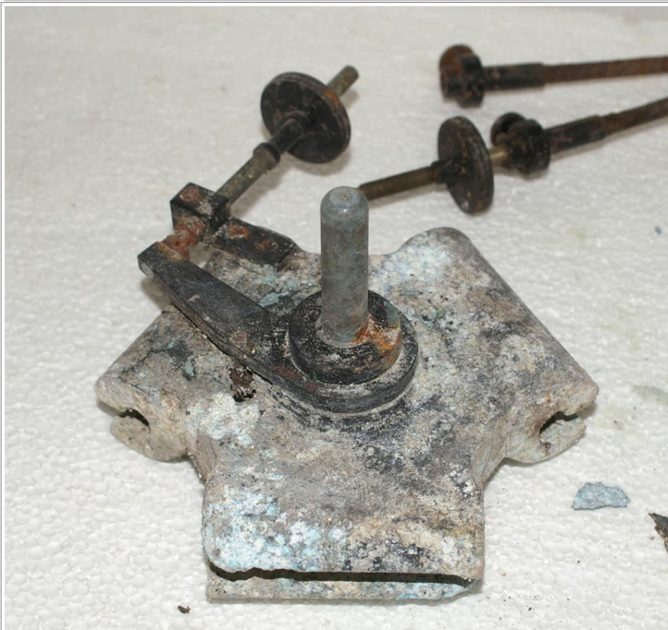
Zeiss Asegur verrottetes Stativplatte 10/2014
