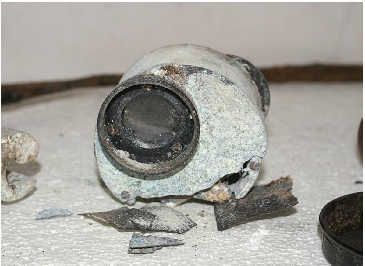
Zeiss Asegur verrottetes Porroprisma 10/2014
