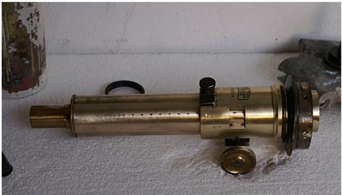
Zeiss Asegur : OAZ nach erster Reinigung und Politur mit 800er und 1200er Körnung
