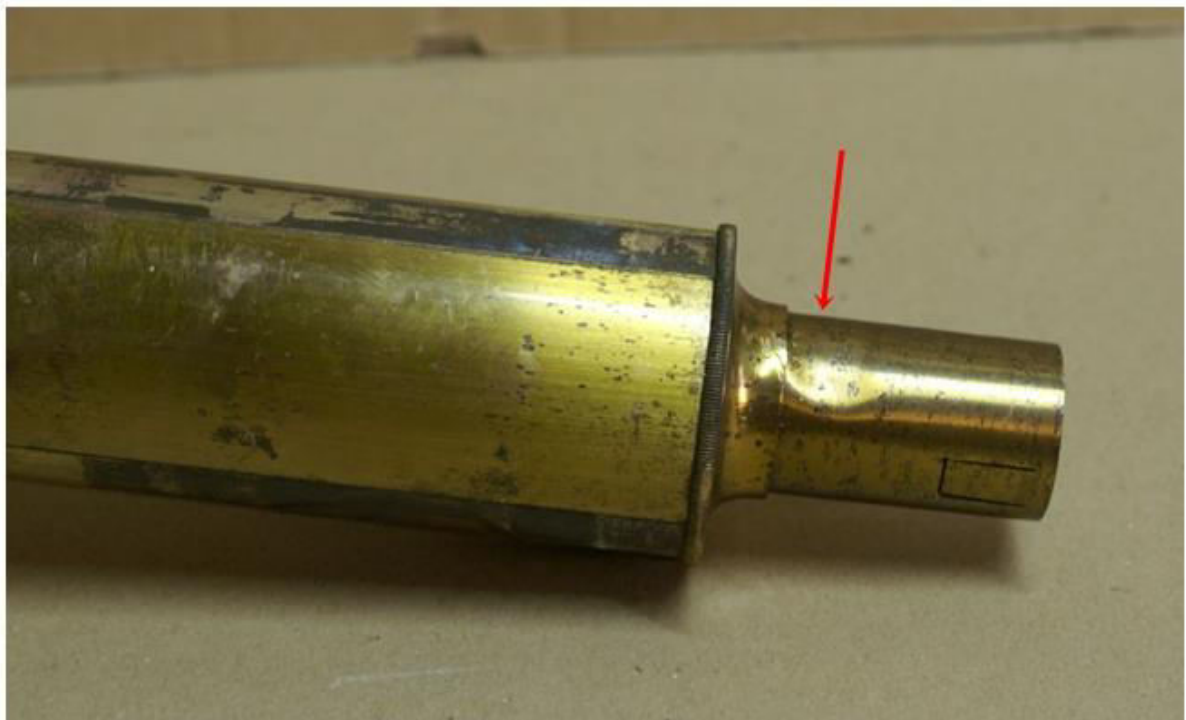
Okularsteckhülse mit kleiner Delle die noch ausgebeult werden muss . 08.10.2014
