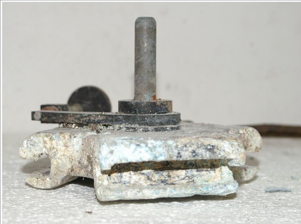
Zeiss Asegur verrottetes Stativplatte 10/2014
