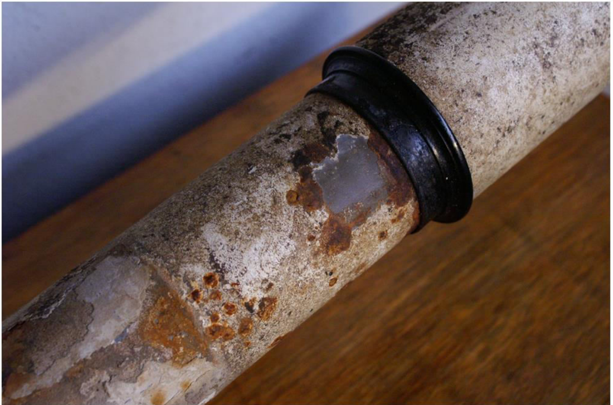
Zeiss Asegur Tubus mit sehr starken Rost und zerstörter Lackierung 10/2014
