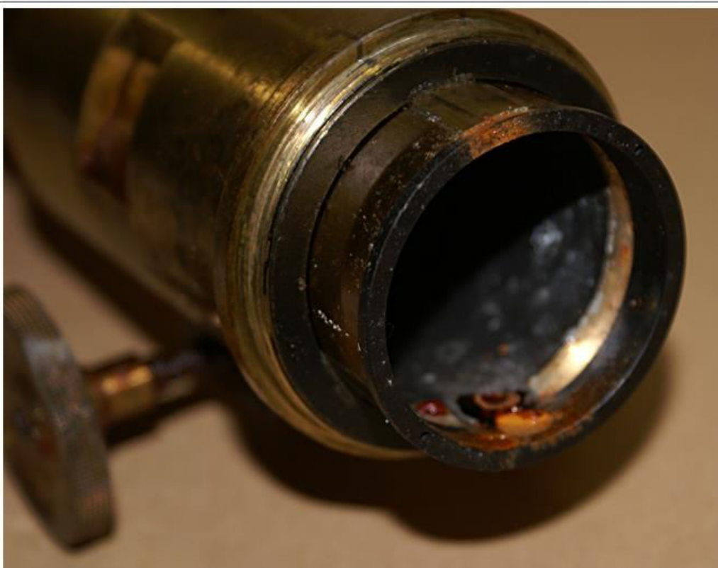
OAZ am 08.10.2014 mit starken Korrosionsspuren und Verfärbungen sogar im Inneren des Auszugsrohres !
