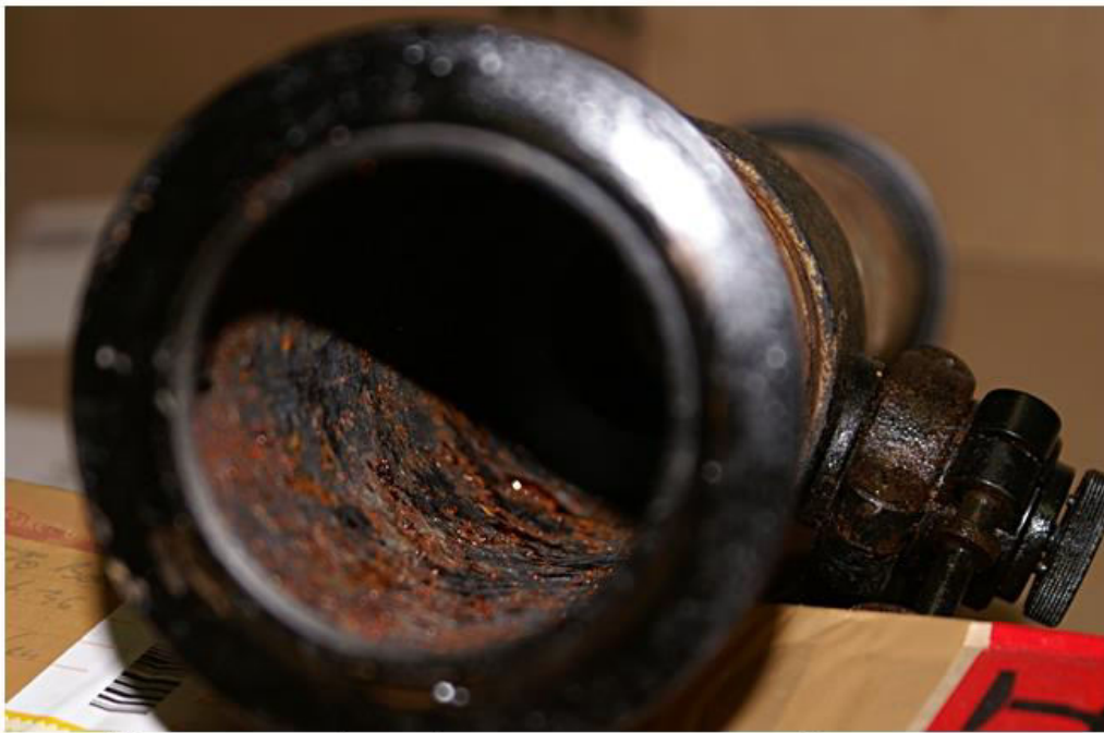
Rostablagerungen im Tubus-Inneren ! Zustand am 08.10.2014 Hier vom Okularauszug aus gesehen.
