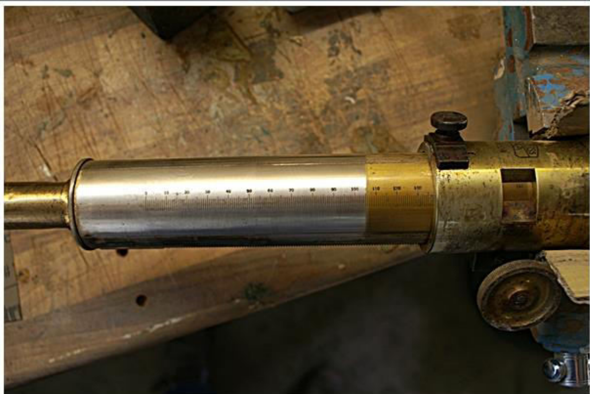
Zeiss Asegur : Reinigen & Polieren des stark korrodierten bzw. angelaufenen Messing-Auszuges am 11.10.2014
