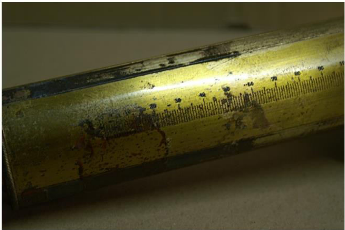
OAZ am 08.10.2014 mit starken Korrosionsspuren und Verfärbungen
