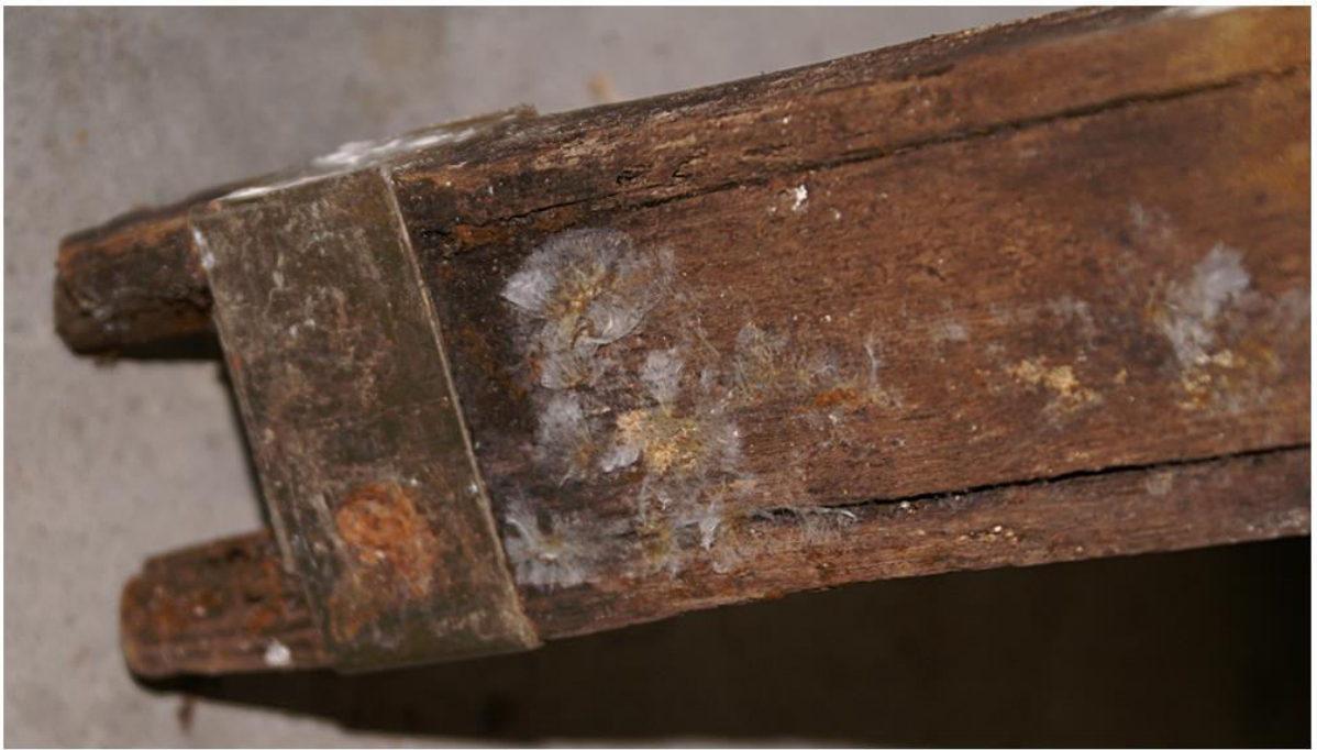
Zeiss Asegur verrottetes Stativ, Schimmel 10/2014
