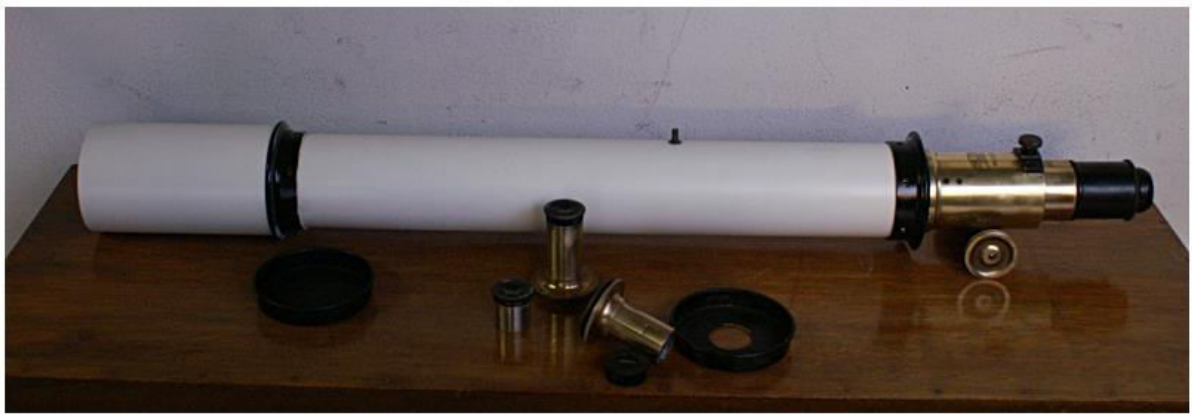
Zwischen-Montage mit neu lackierter Taukappe und dem großen Okular am 20.10.2014 !
