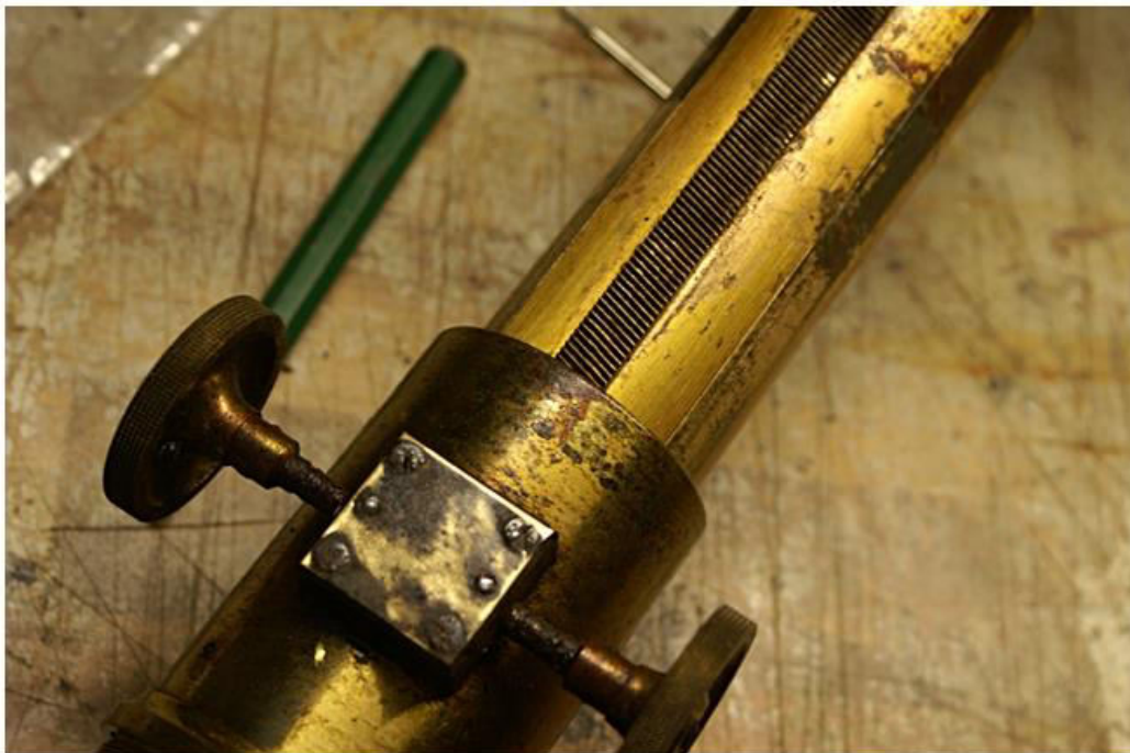
Justierblock für die Gängigkeit des Zahntriebes. Alle Justierschrauben weisen platte und korrodierte Köpfe auf - Zustand 08.10.2014
