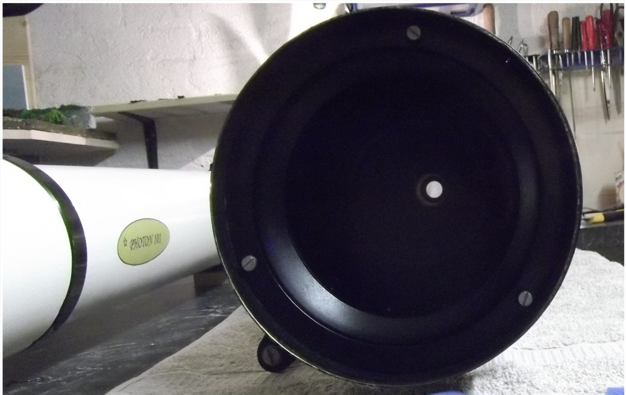
Tubus-Innenschwärzung erneuert, da z.T. noch blanke Messingstellen sichtbar waren
