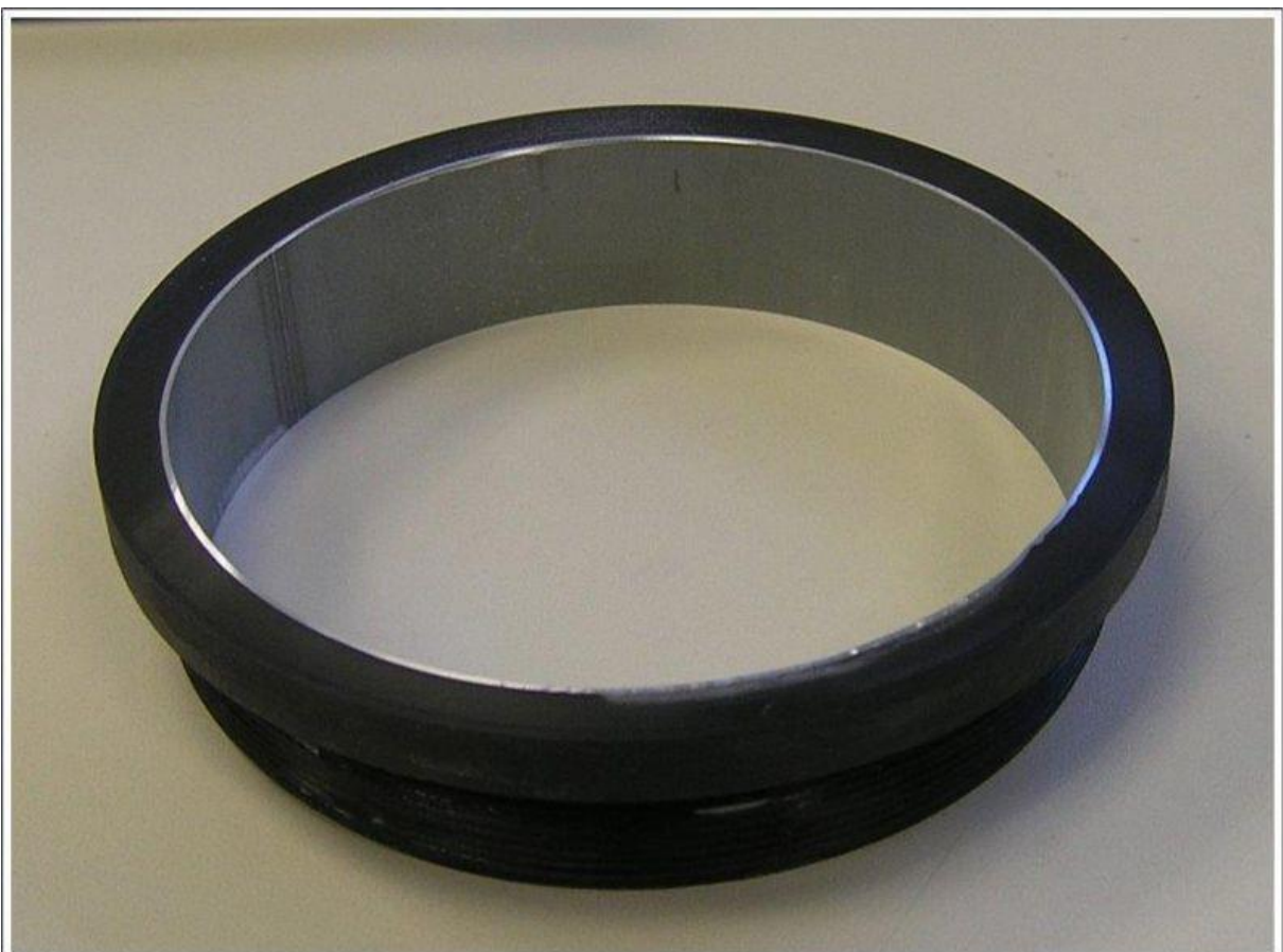
Bresser 102/1350 mm FH Plaste-Objektivvorschraubring mit 0.7 mm Stahlreif verstärkt, freie Öffnung 100,6 mm
