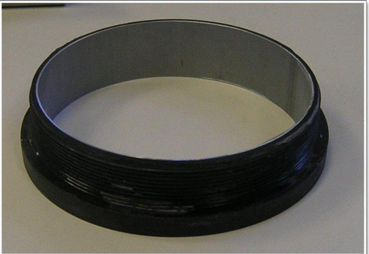
Bresser 102/1350 mm FH Plaste-Objektivvorschraubring mit 0.7 mm Stahlreif verstärkt, freie Öffnung 100,6 mm
